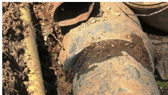
Slika 6 – Prikriveno curenje (vodovodni sistem Herceg Novi – Republika Crna Gora)
